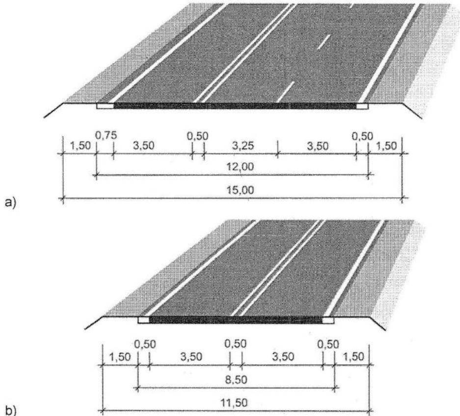
Bild 4.3-2: Regelquerschnitt RQ 11,5+
